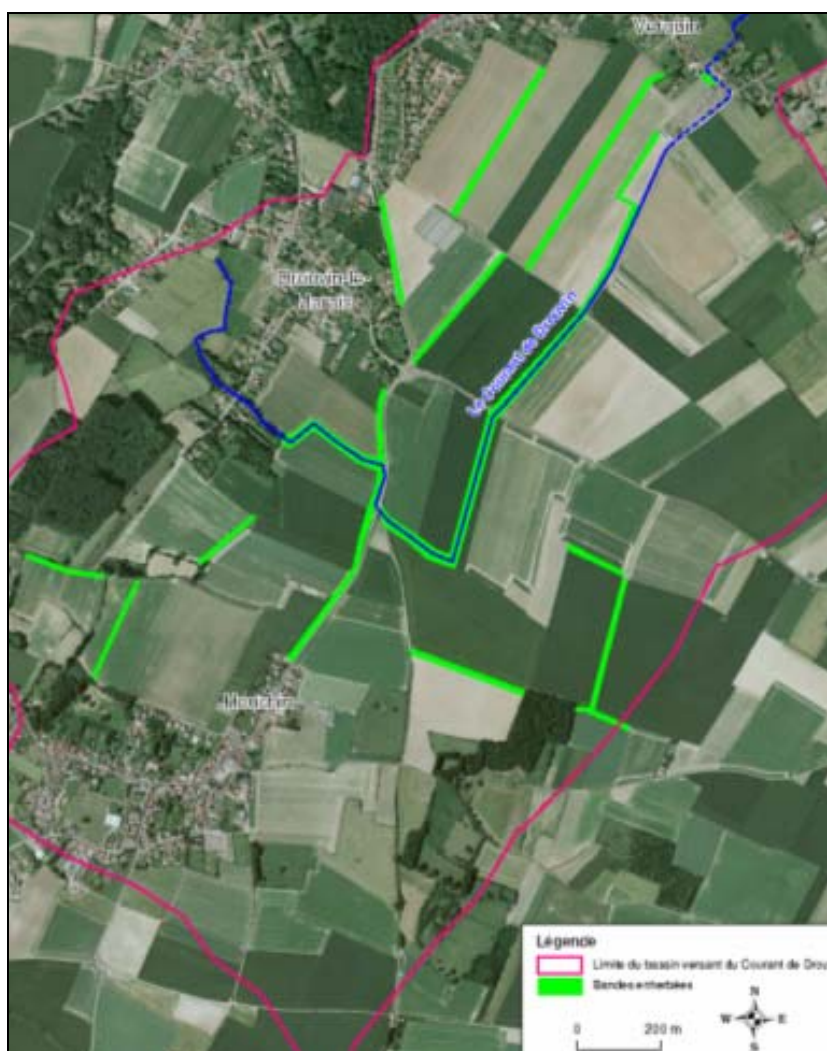
Carte 6 : Implantation de bandes enherbées sur le bassin amont du Courant de Drouvin
